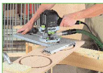
Fræsning af cirkler: Indstilling af diameter, sæt kopiring på OF 1400 – færdig.
